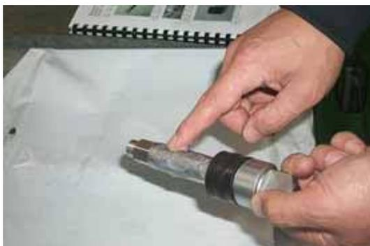
③ Нанесите смазку внутрь гибкого уплотнения и на вал. Не смазывайте плоскую поверхность его конца.
