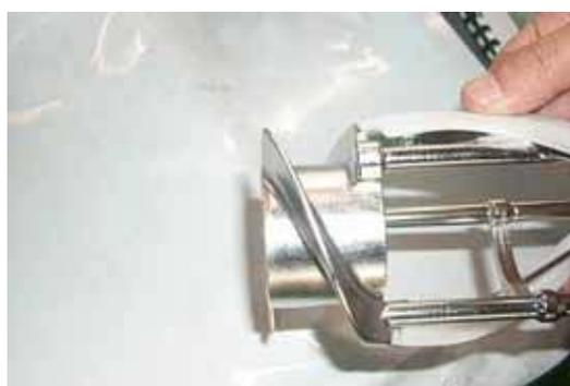
⑥ Наденьте пластиковые лопасти на мешалку. При износе лопастей мешалки снижается производительность машины. Меняйте лопасти каждые три месяца.
