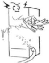
При отключении вилки из розетки беритесь не за шнур питания, а за корпус вилки.
