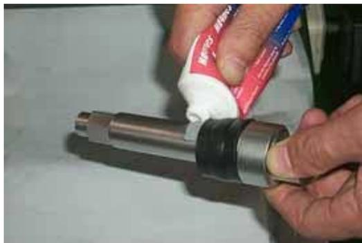
② Установите уплотнение Javaга (гибкое уплотнение) в паз на конце вала и смажьте его.
